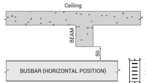
FIGURE-4 BEAM PASSAGE HORIZONTAL POSITION
